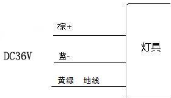
图 5 灯具接线示意图
