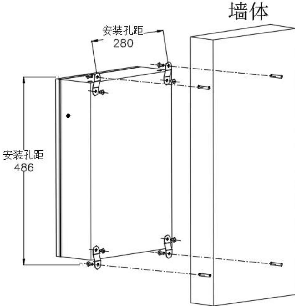
图 4 安装示意图
