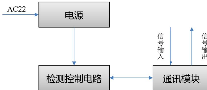
图 3 电路原理方框图
